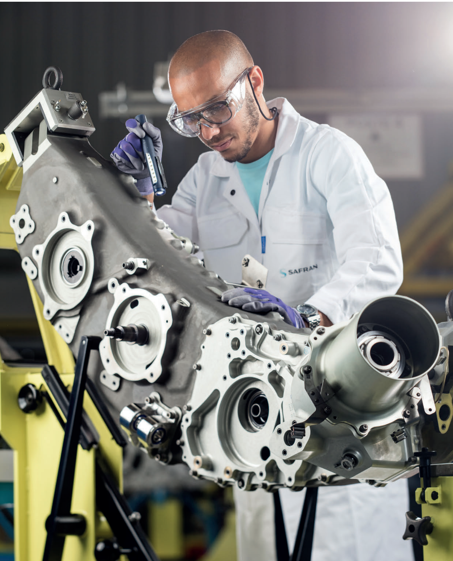
Contrôle qualité AGB (Accessory GearBox) du LEAP 1-B
