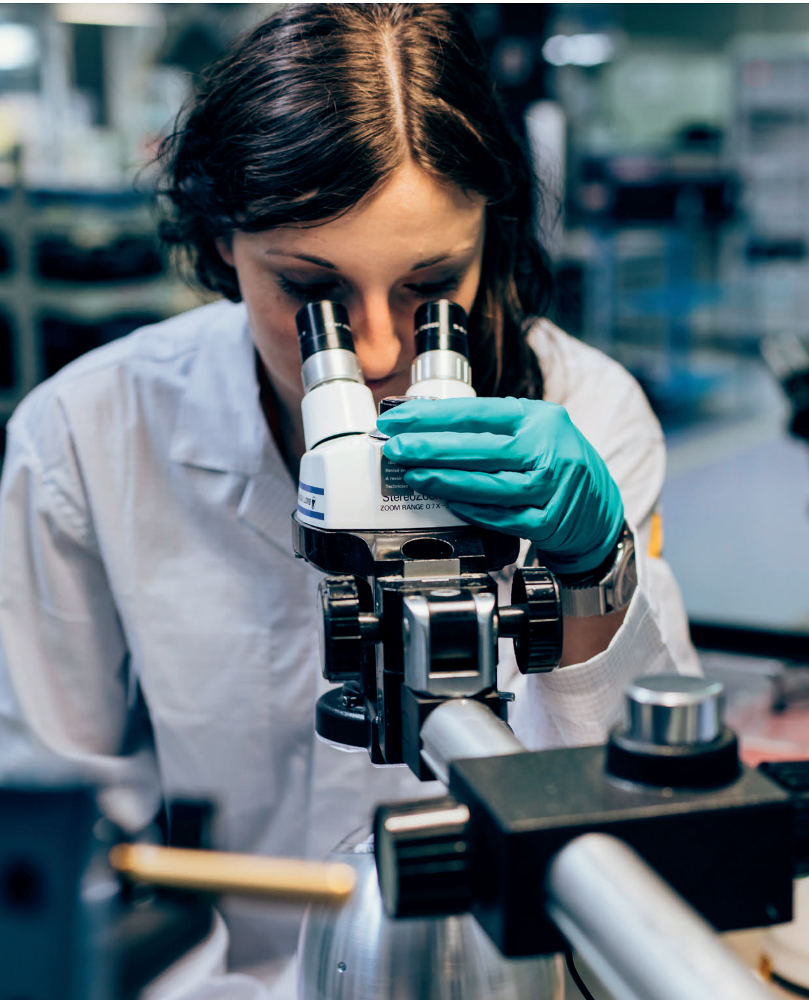
Contrôle d'un autodirecteur au microscope binoculaire
