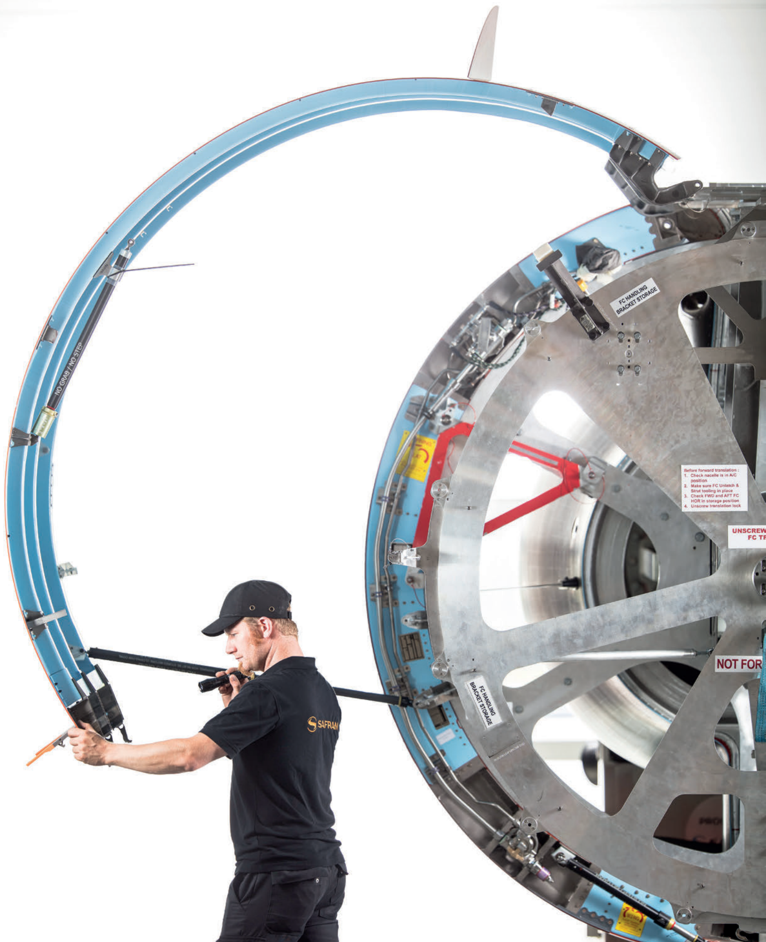
Intégration de la nacelle du moteur LEAP-1-A équipant l'A320neo
